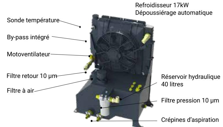
L'Unité Compacte de Refroidissement et Filtration (UCRF) installée sur les COBRA offre une capacité de refroidissement inédite : cet ensemble ultra performant utilise un système de filtration qui intègre un filtre de désaération.
