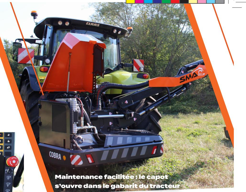
Maintenance facilitée : le capot s'ouvre dans le gabarit du tracteur
